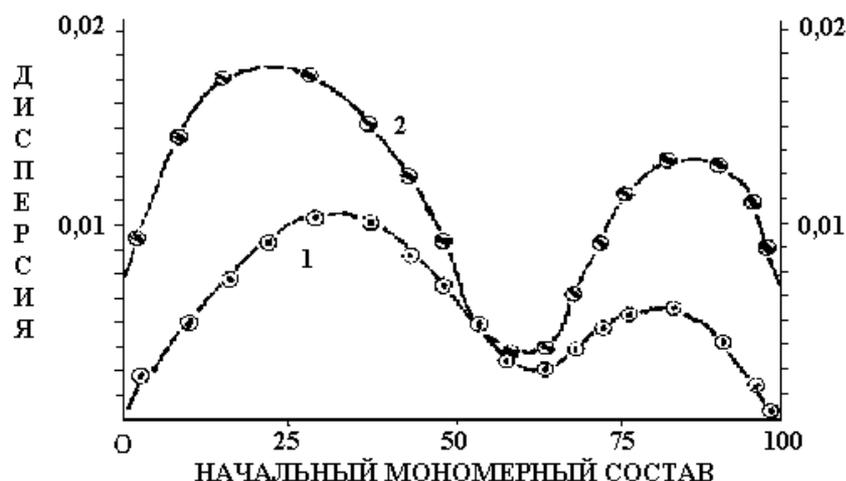
Рис.1. Сополимер МАА : ВКЛ концевая мод. зависимость составов 1 – 1 – компонент, 2 – 2 – компонент , в функции от начального состава, конверсия=5%
