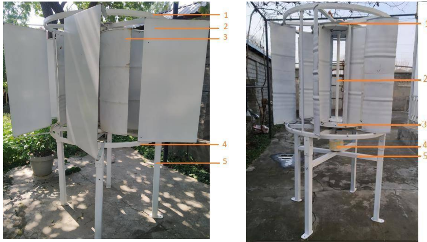
4-rasm. Shamol elektr qurilmasi. 1,4-yo‘naltiruvchi parraklarni ushlab turuvchi xalqalar; 2- yo‘naltiruvchi parraklar; 3- ishchi g‘ildirak parraklari; 5- tutib turuvchi oyoqlari; 6,7-asosiy parraklarni ushlab turuvchi disklar; 8- generator; 9-generatorni tutib turuvchi rama; 10-val.
